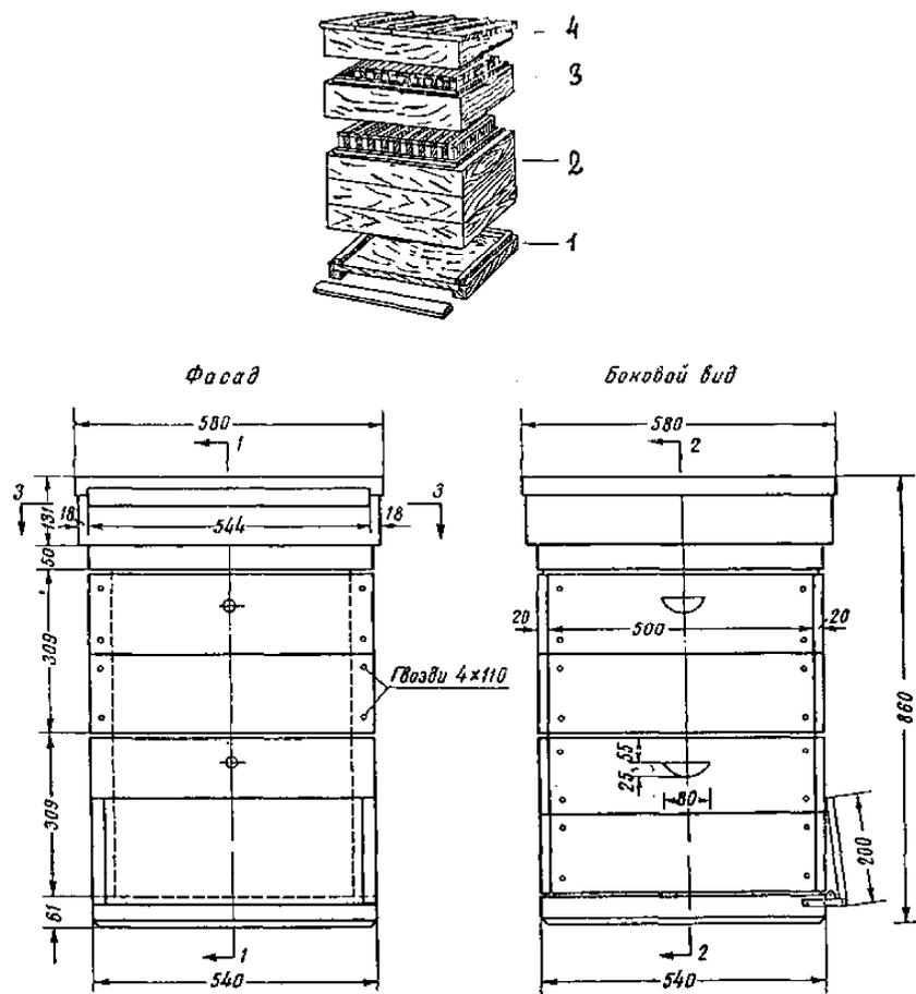
Рис. Е.1. Конструкция улья на 24 рамки:
