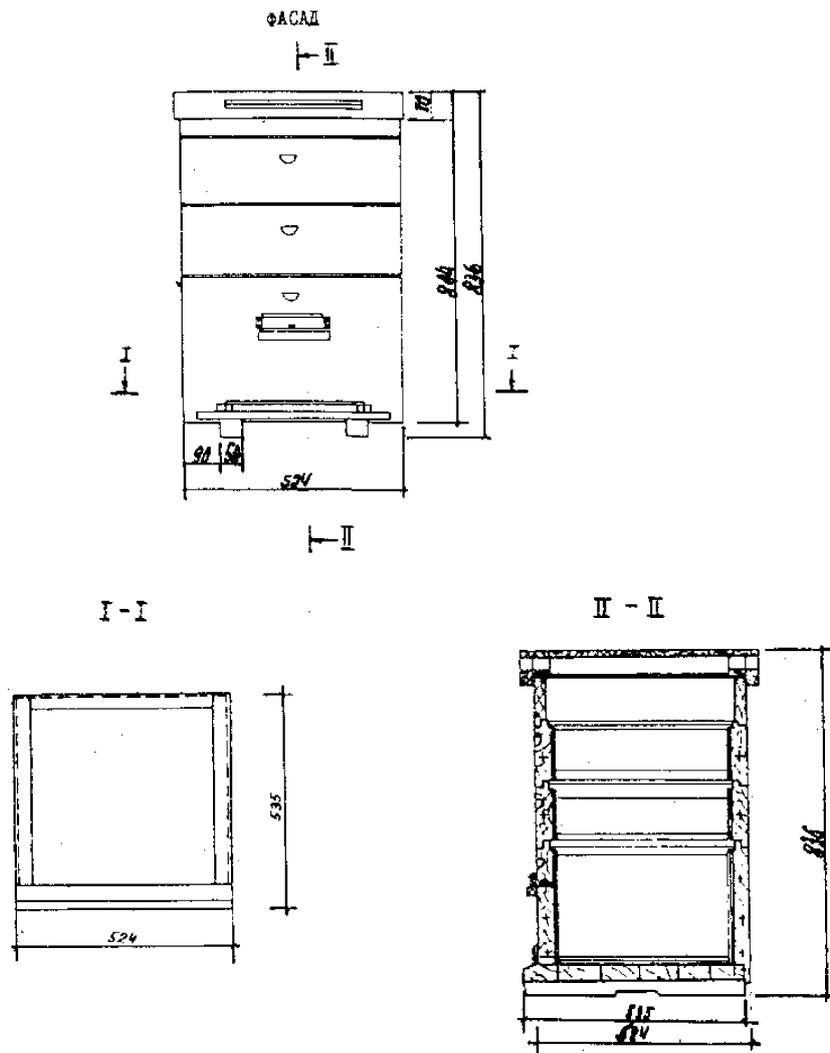
Рис. Е.5. Улей однокорпусный с двумя магазинами
